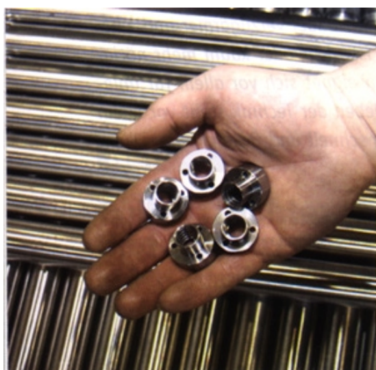
Bild 1. Gasnitrierte Teile weisen unter anderem sehr gute Verschleißigenschaften sowie erhöhte Dauerfestigkeit und Korrosionsbeständigkeit auf.
